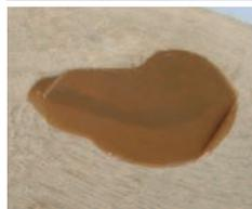
El tiempo de enfriamiento varía de acuerdo con el espesor del Knot Filler inyectado. Pocos segundos para las pequeñas fisuras y las hendiduras, alrededor de un minuto para los orificios más grandes.
